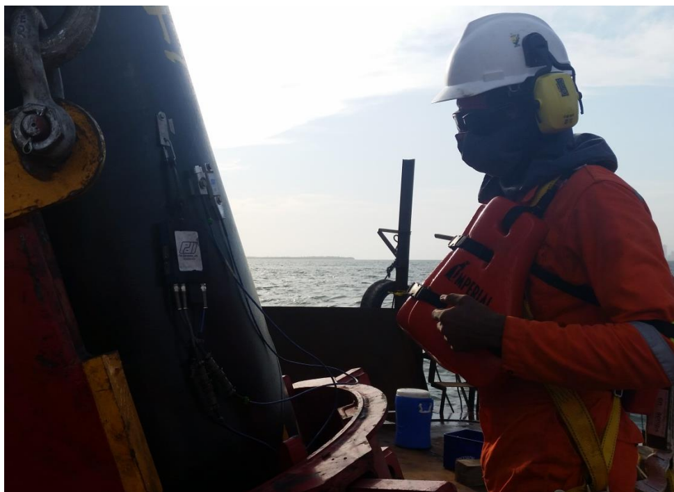
Figura 8. Sensores y transmisores inalámbricos ya instalados
